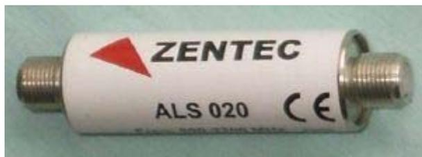
L'amplificateur de ligne (ici pour réception satellite), quel que soit le modèle, sera placé le plus près possible de l'antenne. Il permet de transporter le signal sans perte dans plusieurs dizaines de mètres de câble .
